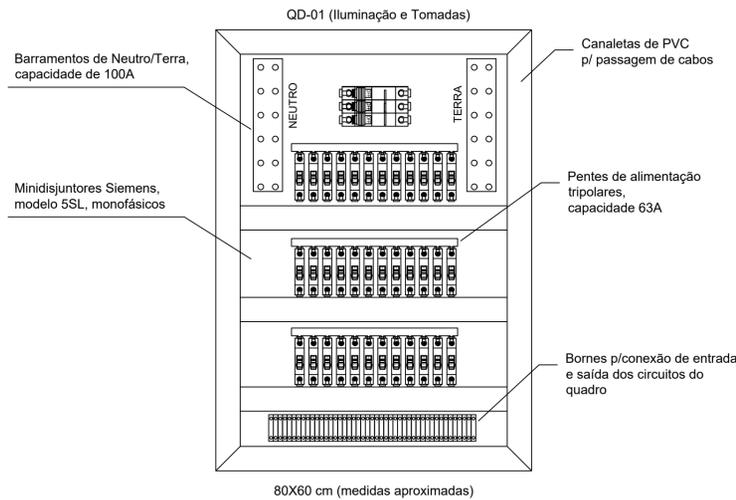
DETALHE 1: Detalhe dos quadros QD-01, QD-02 e QD-03. Estes quadros deverão ser substituídos por novos, disjuntores norma DIN do fabricante Siemens, linha 5SL, disjuntor em caixa moldada na entrada, DRs e DPSs, instalação de barramentos novos de terra e neutro, instalação de pentes de alimentação, barreira de proteção em policarbonato ou chapa de aço, bornes de distribuição (entrada/saída) e canaletas para organização de cabos. Sem Escala
