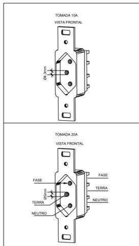
DETALHE 3: Detalhe das tomadas de 10 e 20A- Padrão Brasileiro NBR 14136 Sem Escala
