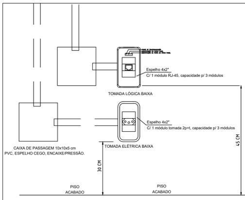
DETALHE 2: Instalação de tomadas baixas e alimentação de caixas de passagem. Sem Escala
