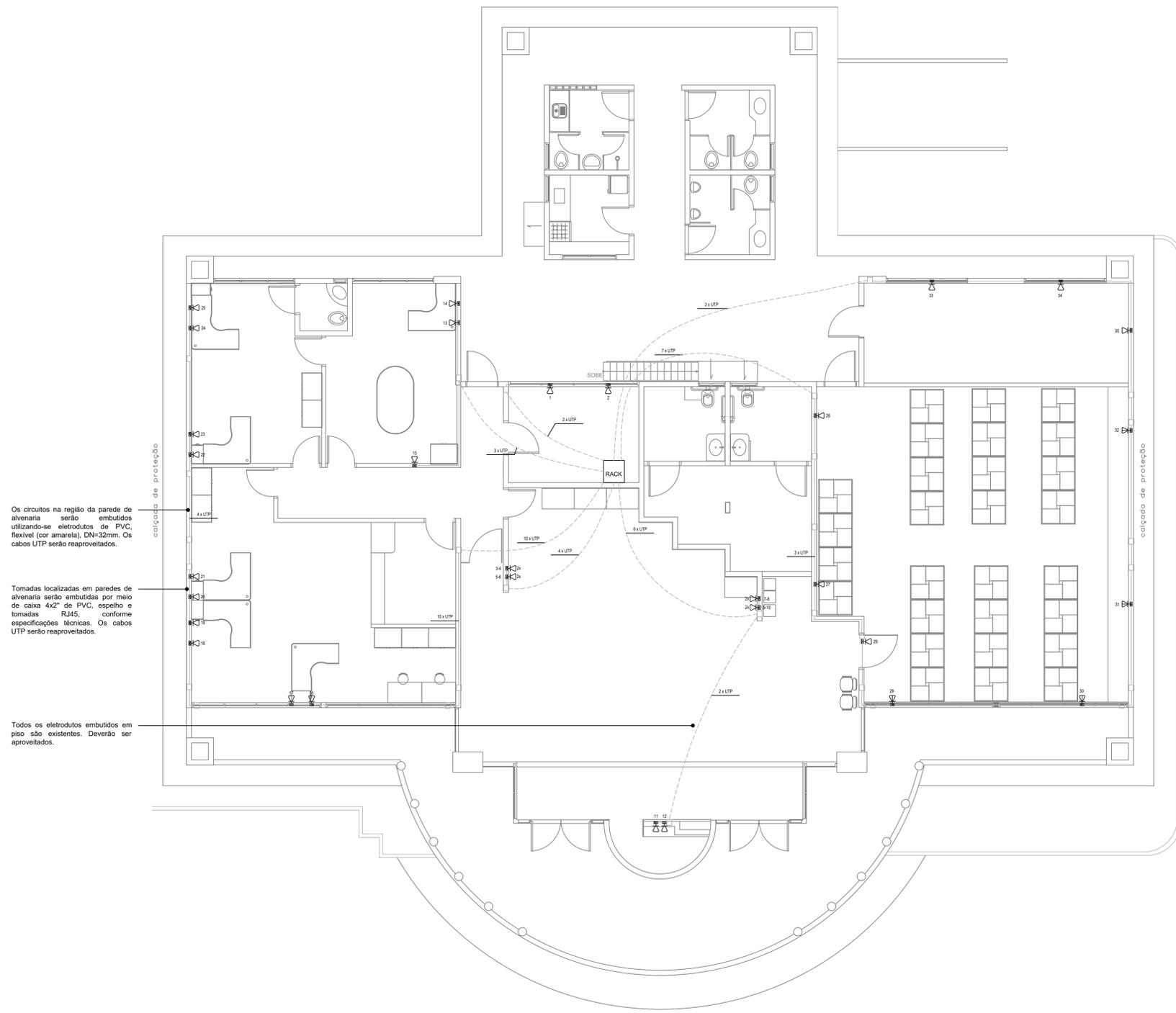
Os circuitos na região da parede de alvenaria serão embutidos utilizando-se eletrodutos de PVC, flexível (cor amarela), DN=32mm. Os cabos UTP serão reaproveitados.
