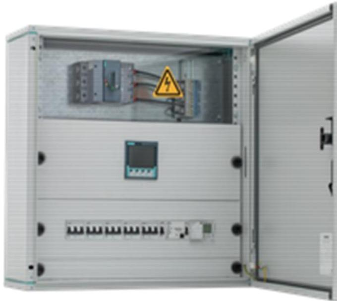
3.28. Os quadros **QD-01**, **QD-02** e **QD-03** deverão ser inteiramente novos, caixa e todos os elementos e acessórios internos novos. A montagem seguirá rigorosamente os projetos e detalhamentos, disjuntor de entrada do tipo caixa moldada (QD-01), barramento tipo pente de alimentação trifásico  $I_n=63A$ , barreira de proteção em policarbonato 3mm ou chapa de aço, barramento de neutro e terra com capacidade mínima de 100 A, bornes de saída para conexão dos cabos dos circuitos, canaletas para
