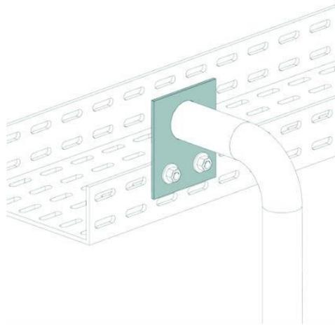
3.14. Para sustentação das eletrocalhas serão utilizados suportes verticais apropriados, parafusados à laje, espaçados a cada 1,5m e perfeitamente nivelados;
