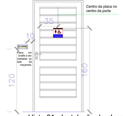
Vista 01 - Instalação de placas nas portas e paredes
