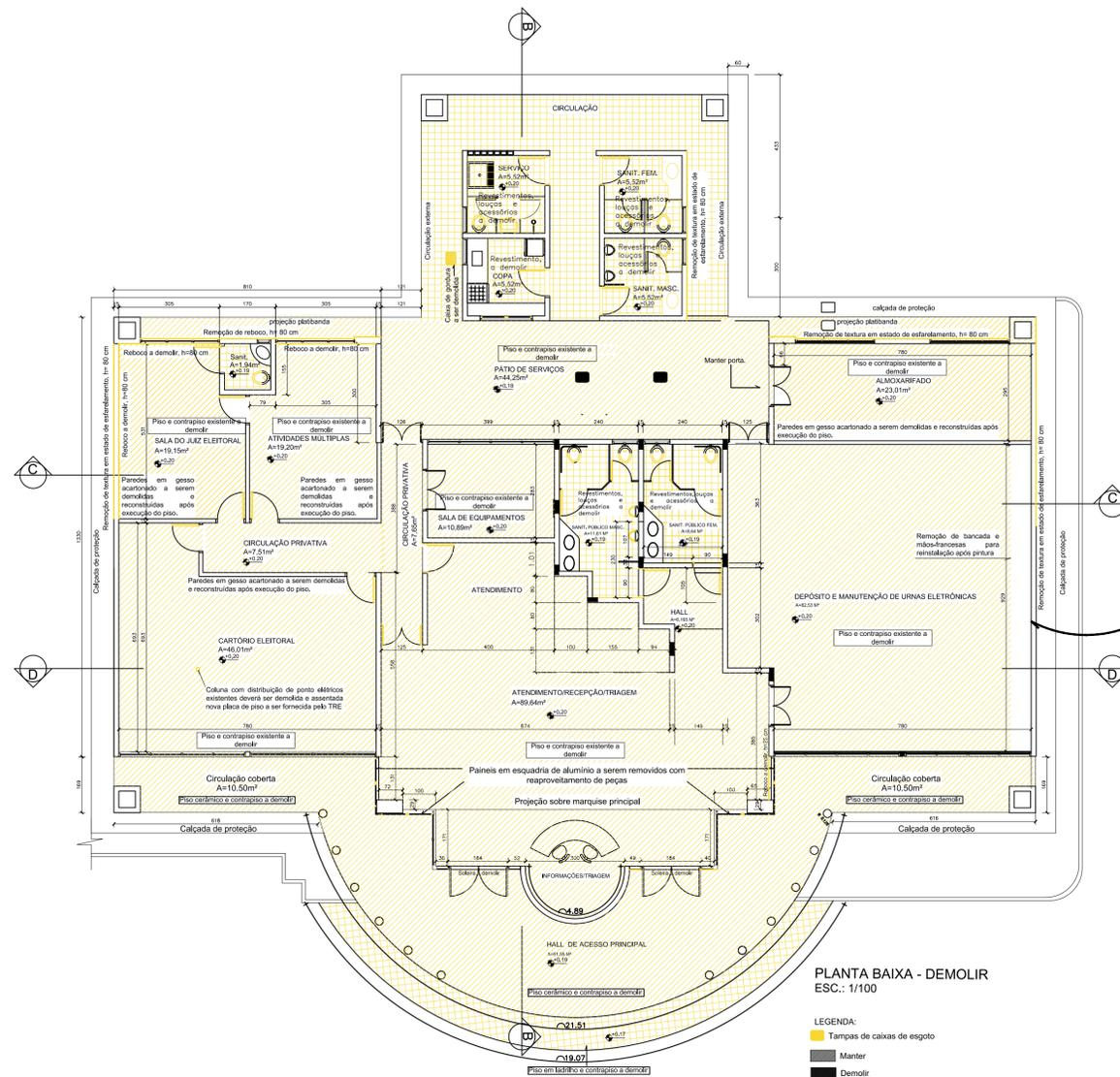
NOTA: Remoção de todas as eletrodutos de parede e execução das instalações elétricas conforme projeto específico.
