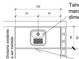
Tanque de embutir em aço inox, marca franke ou equivalente, dimensões de 43x43x25 cm
