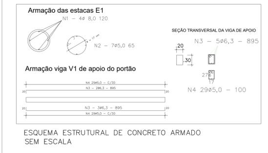
ESQUEMA ESTRUTURAL DE CONCRETO ARMADO SEM ESCALA
