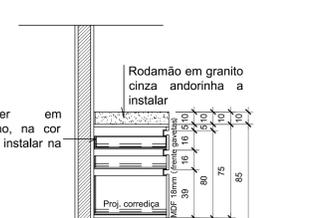
Base em alvenaria de tijolo maciço e revestimento em rodapé de granito cinza andorinha, h= 10 cm
