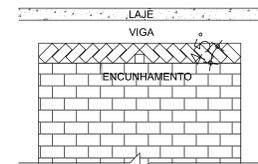
Detalhe 03 - Encunhamento - Janela e vãos do caixão de ar condicionado
