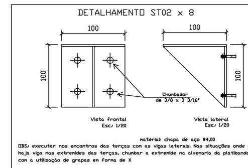
OBS: executar nos encontros das terças com as vigas laterais. Nas situações onde não haja viga nas extremidades das terças, chumbar a extremidade na alvenaria da platibanda com a utilização de grapas em forma de X
