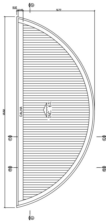
Telhamento com telha termoisolante revestida em aço galvanizado, faces superior e inferior em telha trapezoidal, revestimento com espessura de 0,50mm com pré-pintura nas duas faces, núcleo em poliestireno (EPS) de 50mm
