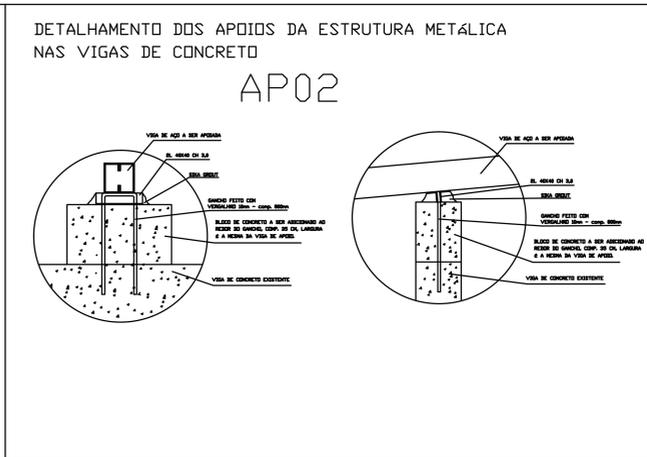
OBS: PROIBIDO SOLDAR QUALQUER PEÇA À FERRAGEM DA ESTRUTURA DO PRÉDIO
