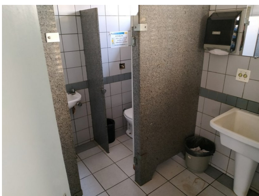
Foto 43 – Atual espaço da área de serviço a ser transformado em sanitário masculino. Troca de revestimentos, execução de novos pontos de água e esgoto, ligação dos pontos com redes de distribuição, troca de portas, instalação de bancadas e de armários.
