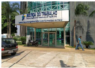
Foto 13 –Marquise – Letreiro, revestimento, forro em PVC e luminárias existentes a remover e executar novos revestimentos e acabamentos
