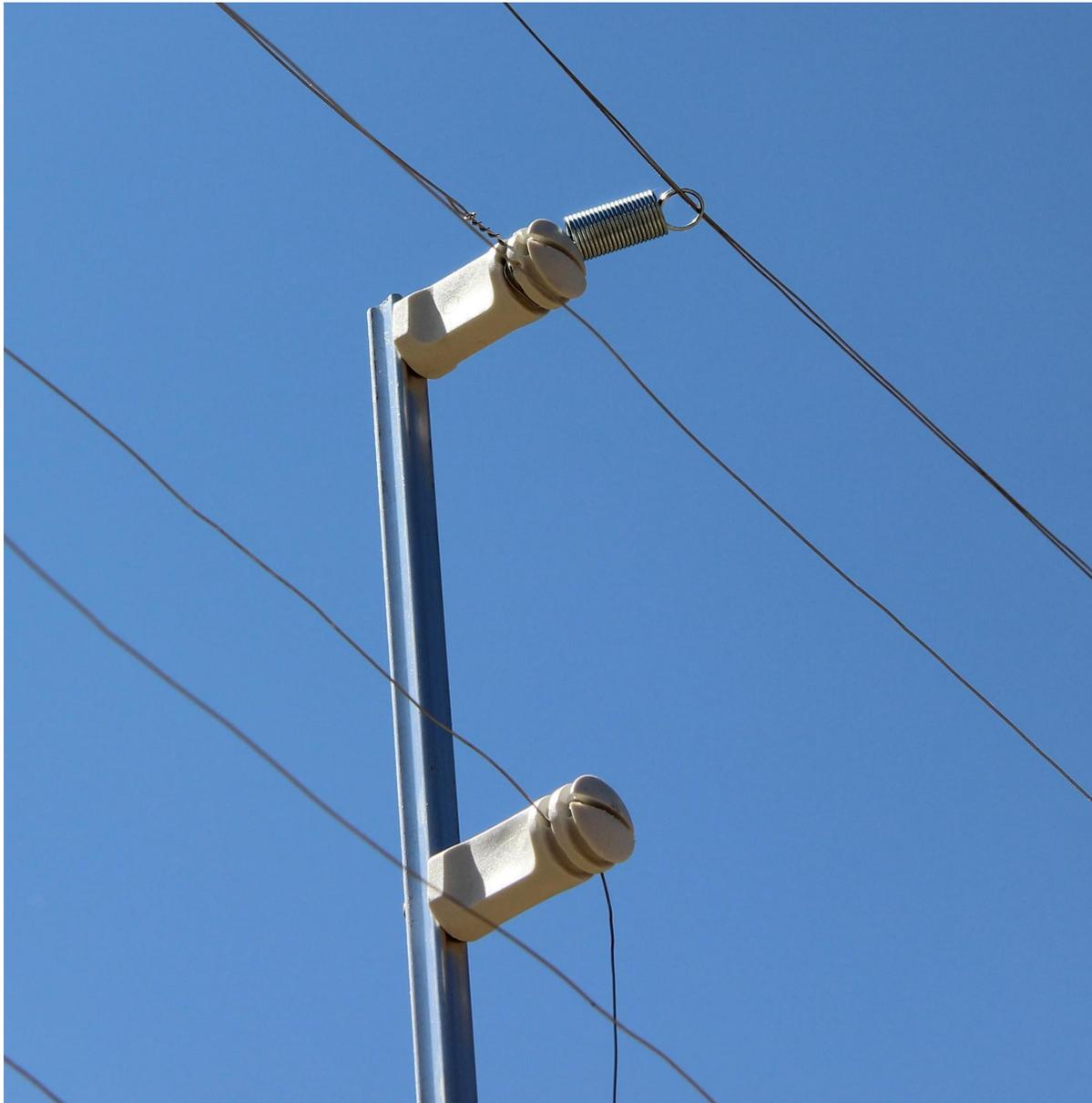
Figura 4 - Detalhe do contato elétrico entre a cerca do portão e a cerca do gradil.
